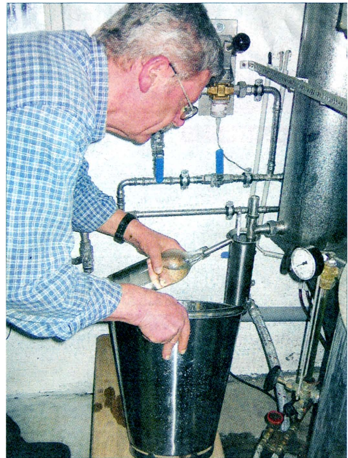
Brennereileiter Horst Hochwind beim Abzweigen frisch destillierten Obstlers zur Kontrolle des Alkoholgehalts. Foto: privat
